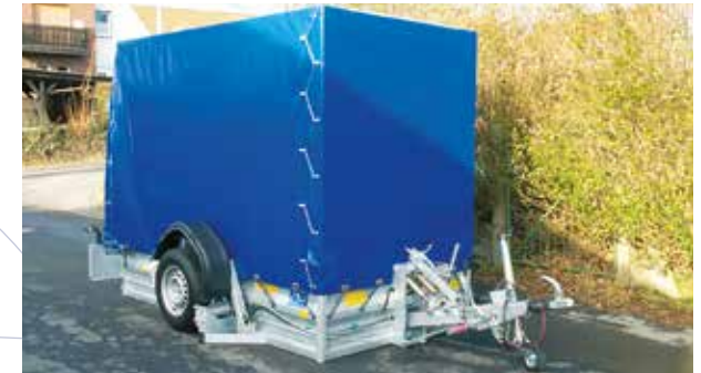
Presenning som er fastgjort i hjørnerne med strop.
