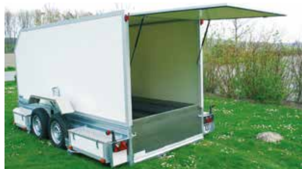
Lukket kasse-trailer med bagklap som åbnes opad.
