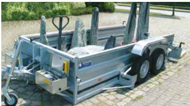
Godset kan læses sikkert og forsvarligt ved brug af surringsringene der er indbygget i bunden.
