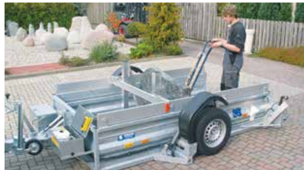
Klemmelåsen kan flyttes variabelt over trailerens længde.
