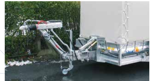
Højde justerbar træk, koblings højde max. 1100 mm.
