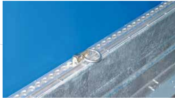
Airline-skinne med forbindelsesring monteret på toppen af sidevæggene.
