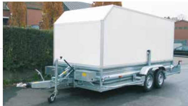
PT35 med lukket kasse og en 45 graders front i kørselsretningen.
