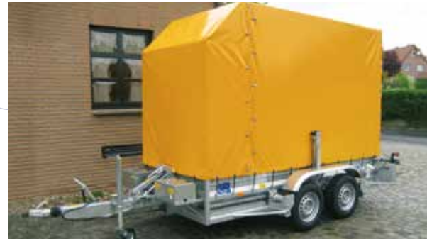
Presenning med 45 graders vinkel i front.
