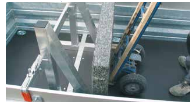
Klemmelås til transport af specielle produkter - her på billedet en granit sten.
