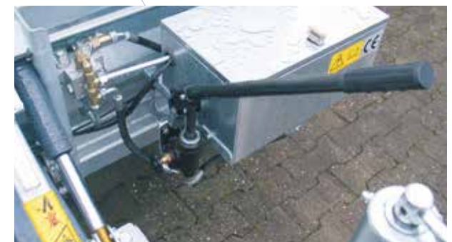
Elektrisk pumpe med nød håndpumpe.
