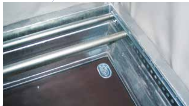
Tværstang til sikring samt opdeling af gods.
