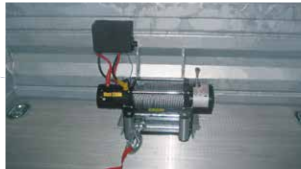
Elektrisk spil monteret i ladbunden.
