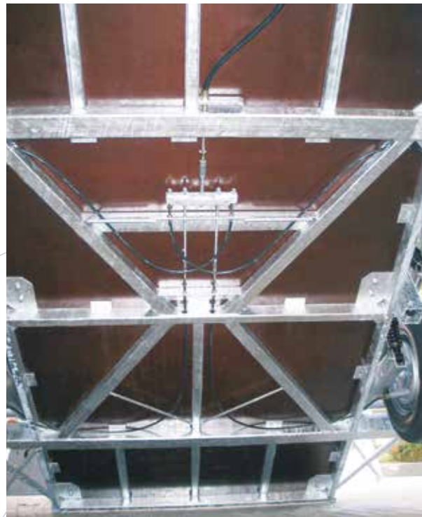
Multiplex træplade som bundramme - standard på alle modeller.
