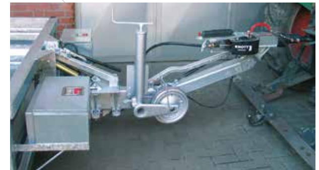
Højde justerbar træk med trækøje og forstærket støttehjul.
