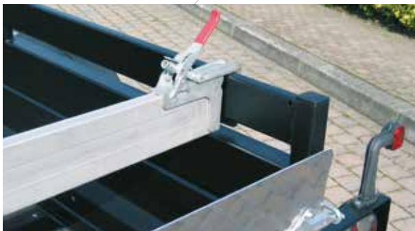
Forhøjet sider med klemmelås.
