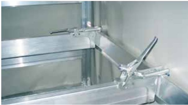
Rumdeler med lås til at klemme på rammen.
