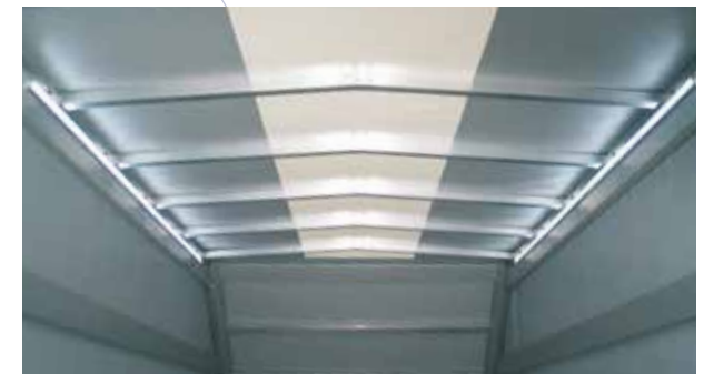
Indvendig LED belysning 12 eller 24 volt til opbygninger med presenningsramme eller kasse.
